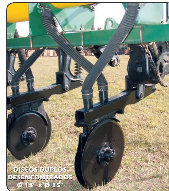
FRISOS LIMITADORES DE PROFUNDIDADE Ø 260 ou Ø 280 mm acoplados aos discos duplos.
