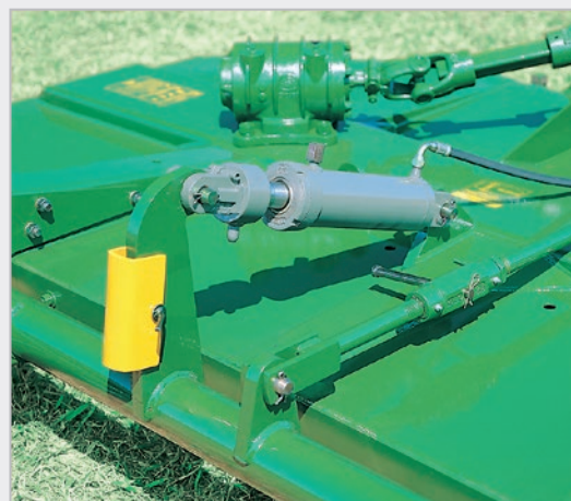
Regulador da altura de corte no cilindro. Varão estabilizador para nivelamento da roçadeira.
