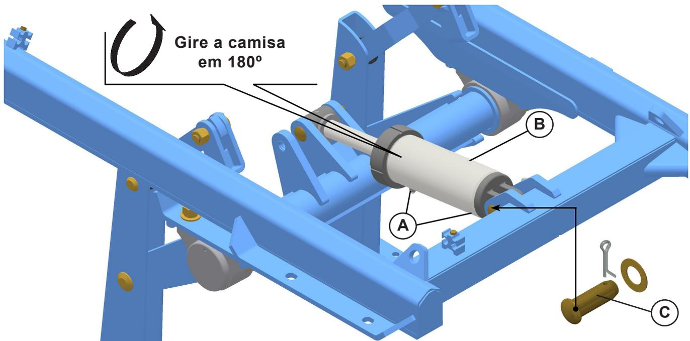
2. Em seguida faça a movimentação de 180°, deixando os terminais (A) virados para cima e permanecendo a haste do cilindro voltada para a direção do rodado (D) da grade, como ilustra a figura.
