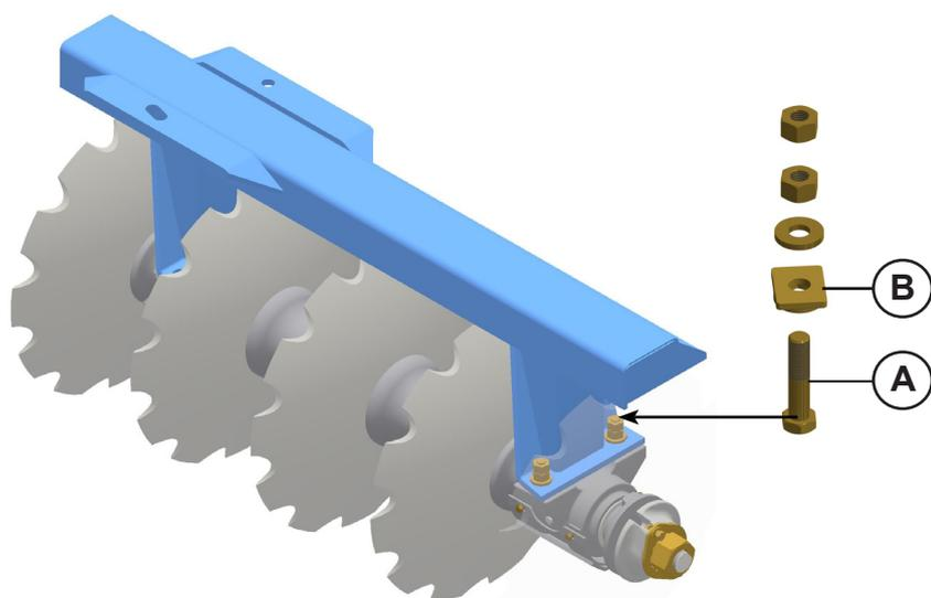
2. Coloque o parafuso (A) com arruela quadrada (B), passando pela caixa do mancal e pelo orifício da sapata. Por cima, coloque arruela lisa e porcas.
