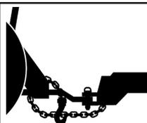
Ao acoplar o equipamento ao trator, utilize uma corrente para travar o cabeçalho do equipamento à barra de engate do trator. Esta medida evitará que as mangueiras hidráulicas venham a se romper ou o equipamento venha a empinar em caso de quebra do sistema de engate.
