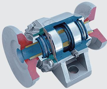
Mancais com dois rolamentos de rolos cônicos, lubrificados a graxa (CM) ou em banho de óleo permanente - DUROMARK<sup>®</sup> (DM).
