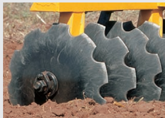
Discos: recortados de alta resistência ao desgaste e aos impactos.
